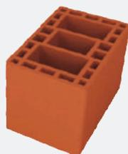
Parede de alvenaria com bloco cerâmico estrutural 190x190x290mm – 5 MPa – com dimensão de 4,12 x 3,20 metros, assentados com argamassa grossa industrializada de 2cm em ambos os lados e com peso aproximado de 192 kg/m<sup>2</sup>. Espessura total da parede 23 cm.
