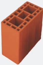
Parede de alvenaria com bloco cerâmico estrutural 115x190x290mm – 7 MPa – com dimensão de 4,12 x 3,20 metros, assentados com argamassa grossa industrializada de 2cm em ambos os lados e com peso aproximado de 181 kg/m<sup>2</sup>. Espessura total da parede 15,5 cm.
