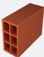
A parede de alvenaria foi construída com bloco cerâmico de vedação horizontal 90x190x290mm – 1,5 MPa – com dimensão total de 4,12 x 3,20 metros e com peso aproximado de 153 kg/m<sup>2</sup>. Os blocos foram assentados com argamassa grossa industrializada com espessura de assentamento vertical e horizontal de 10 a 13mm. O revestimento foi executado com argamassa grossa industrializada aplicado sobre o chapisco, com espessura total de 20mm, em ambas as faces. Espessura total da parede de 13 cm.
