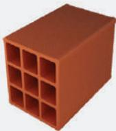
Parede de alvenaria com bloco cerâmico de vedação horizontal 140x190x290mm – 1,5 MPa – com dimensão de 4,12 x 3,20 metros, assentados com argamassa grossa industrializada de 2 cm em ambos os lados e com peso aproximado de 198 kg/m<sup>2</sup>. Espessura total da parede 18 cm.
