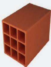
A parede de alvenaria foi construída com bloco cerâmico de vedação horizontal 140x190x290mm – 1,5 MPa – com dimensão total de 4,12 x 3,20 metros e com peso aproximado de 198 kg/m<sup>2</sup>. Os blocos foram assentados com argamassa grossa industrializada com espessura de assentamento vertical e horizontal de 10 a 13mm. O revestimento foi executado com argamassa grossa industrializada aplicado sobre o chapisco, com espessura total de 20mm, em ambas as faces. Espessura total da parede de 18 cm.
