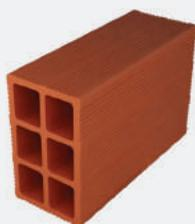
A parede de alvenaria foi construída com bloco cerâmico de vedação horizontal 115x190x290mm – 1,5 MPa – com dimensão total de 4,12 x 3,20 metros e com peso aproximado de 172 kg/m<sup>2</sup>. Os blocos foram assentados com argamassa grossa industrializada com espessura de assentamento vertical e horizontal de 10 a 13mm. O revestimento foi executado com argamassa grossa industrializada aplicado sobre o chapisco, com espessura total de 20mm, em ambas as faces. Espessura total da parede de 15,5 cm.
