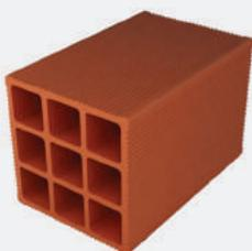
A parede de alvenaria foi construída com bloco cerâmico de vedação horizontal 190x190x290mm – 1,5 MPa – com dimensão total de 4,12 x 3,20 metros e com peso aproximado de 279 kg/m<sup>2</sup>. Os blocos foram assentados com argamassa grossa industrializada com espessura de assentamento vertical e horizontal de 10 a 13mm. O revestimento foi executado com argamassa grossa industrializada aplicado sobre o chapisco, com espessura total de 30mm, em ambas as faces. Espessura total da parede de 25 cm.
